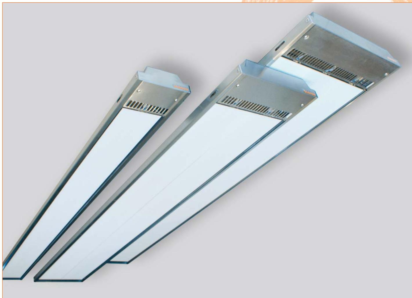
В высокотемпературных обогревателях ECOSUN источником ИК-излучения является стальной тен. Он расположен внутри алюминиевой пластины, покрытой специальным составом SILICATING для значительного повышения коэффициента излучения. Одна или несколько панелей (в зависимости от мощности обогревателя) установлены в корпусе из окрашенной стали. Номинальная мощность, благодаря применению технологии SILICATING составляет 8,76 кВт/м<sup>2</sup>. Максимальная температура нагрева панели — 350°C.
